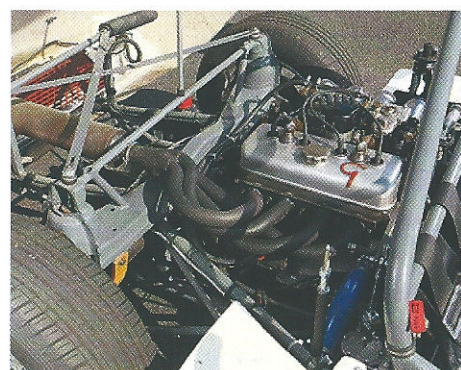
Sur la barquette Fournier-Marcadier, le moteur est disposé au centre.
