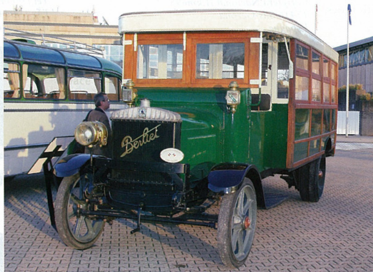
Sur l'esplanade extérieure d'Eurexpo la Fondation berliet exposait un autobus Berliet de transport du personnel type CBI de 1918, sur châssis CBA et transmission à chaînes. Il était affecté à l'usine de Vénissieux au transport du personnel de la région du Nord Dauphiné.
